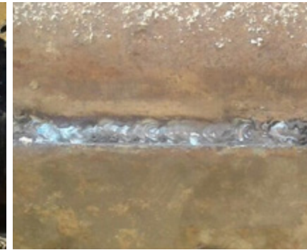
Tadilat Ve Kaynak Sonrası Çelik Boru
